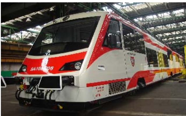
Rys.21 – Autobus szynowy dwuczłonowy serii SA108 (215M) produkcji ZNTK Poznań dla PKP Przewozy Regionalne
