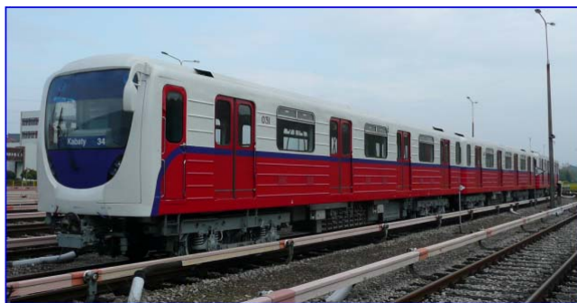
Rys.1 – Pociąg wagonów metra serii 81 produkcji ZAO Wagonmasz
