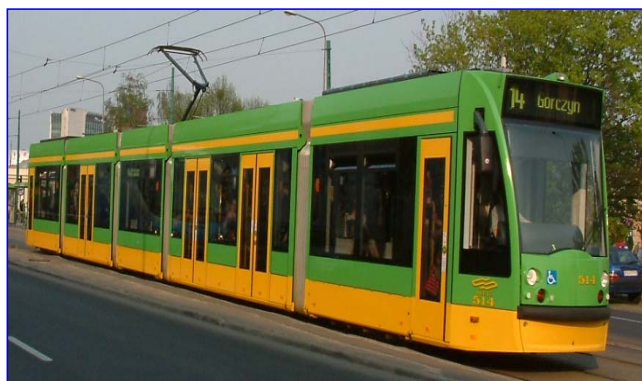
Rys.5 – Tramwaj niskopodłogowy pięciocłonowy typu RB2 (Combino) produkcji Siemens dla Miejskiego Przedsiębiorstwa Komunikacji Miejskiej w Poznaniu
