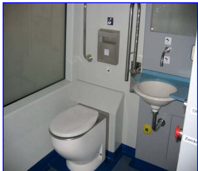
Rys.28 – Widok na toaletę WC zastosowaną w elektrycznym autobusie szynowym Serii EN81
