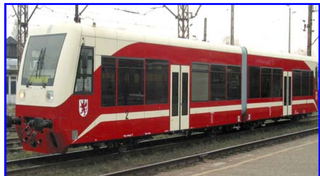
Rys.23 – Autobus szynowy dwuczłonowy serii SA108 (212M) produkcji Kolzam Racibórz
