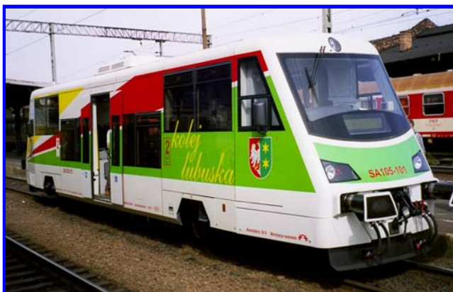
Rys.20 – Autobus szynowy jednoczłonowy serii SA105 (213M) produkcji Poznańskich Zakładów Taboru Kolejowego na potrzeby Kolei Lubuskiej
