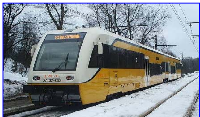
Rys.25 – Dwuczłonowy autobus szynowy serii SA133 (218M) produkcji Pesa Bydgoszcz
