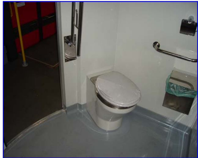
Rys.27 – Widok na toalety WC zastosowaną w spalinowym autobusie szynowym serii SA108
