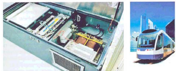
Rys.30 – Zasada zastosowania mobilnego zasobnika energii dla zasilania tramwaju Combino
