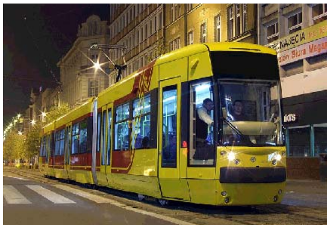
Rys.4 – Tramwaj typu 118N niskopodłogowy trójczłonowy produkcji FPS H. Cegielski na ulicach Poznania
