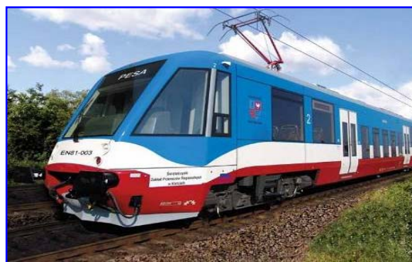
Rys.14 – Elektryczny autobus szynowy serii EN81 produkcji „Pesa” Bydgoszcz
