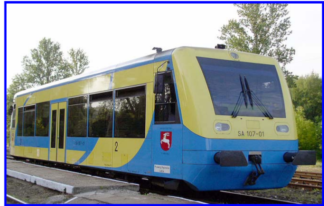
Rys.22 – Autobus szynowy jednoczłonowy serii SA107 (211M) produkcji Kolzam Racibórz
