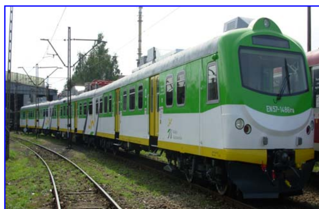
Rys.18 – Zmodernizowany elektryczny zespół trakcyjny EN57 KM dla Kolei Mazowieckich
