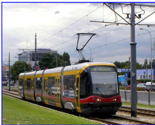
Rys.6 – Tramwaj pięciocłonowy niskopodłogowy typu 120N produkcji Pesa Bydgoszcz dla Spółki Tramwaje Warszawskie
