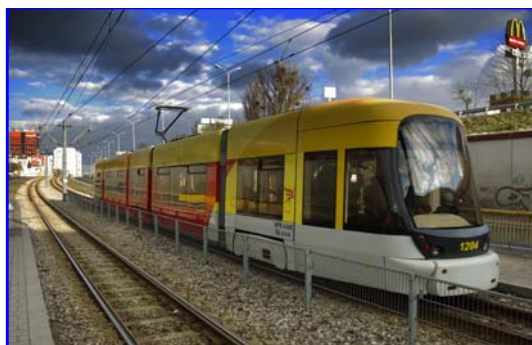
Rys.7 – Tramwaj pięciocłonowy niskopodłogowy typu Cityrunner produkcji Bombardier dla Łódzkiego MPK
