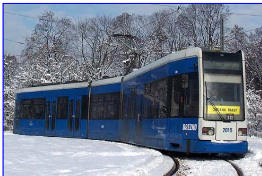
Rys.8 – Tramwaj trójczłonowy niskopodłogowy typu NGT6 produkcji Bombardiera dla MPK Kraków
