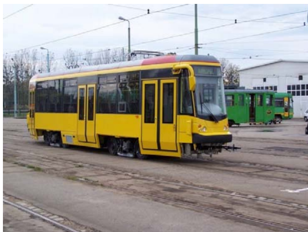
Rys.10 – Tramwaj wysokopodłogowy jednoczłonowy typu 123N produkcji FPS – H. Cegielski dla Spółki Tramwaje Warszawskie
