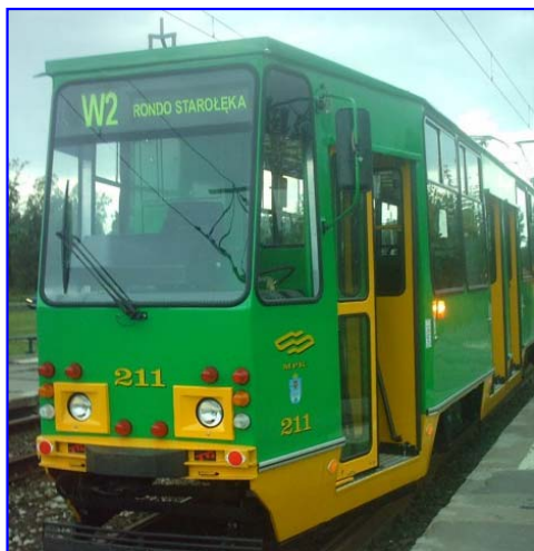
Rys.3 – Tramwaj typu 105N produkowany w latach 1973 ÷ 2001 przez Chorzowski Konstal (najpopularniejszy tramwaj w Polsce)
